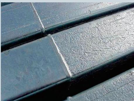
Deutlich sind die unterschiedlichen Oberflächenstrukturen an den zusammengeschweißten Stahlprofilen trotz gleichem Verzinkungsprozess zu erkennen.
