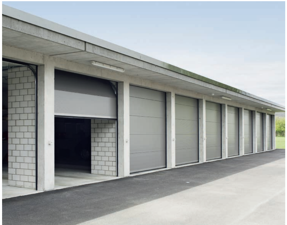
Thermisch getrennte Tore verlagern bei Garagen die Dämmebene direkt an die Fassadenflucht. Dans les garages, les portes à isolation thermique ramènent la couche isolante directement au niveau du plan de façade.
