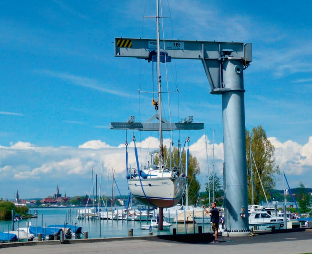
Der neue Schiffskran hebt und dreht 16 t. La nouvelle grue portuaire soulève et déplace 16 tonnes.
