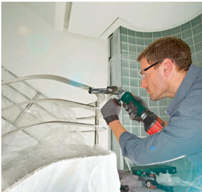
Universal einsetzbar ist die Akku-Bandfeile BF 18 LTX 90 - beispielsweise zum Schleifen von Edelstahl-Rohren oder zum Satinieren.
