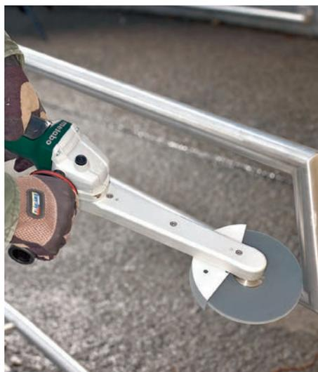
Mit dem Akku-Kehlnahtschleifer KNS 18 LTX 150 lassen sich Edelstahl-Kehl Nähte verschleifen, ohne angrenzende Oberflächen zu beschädigen.
