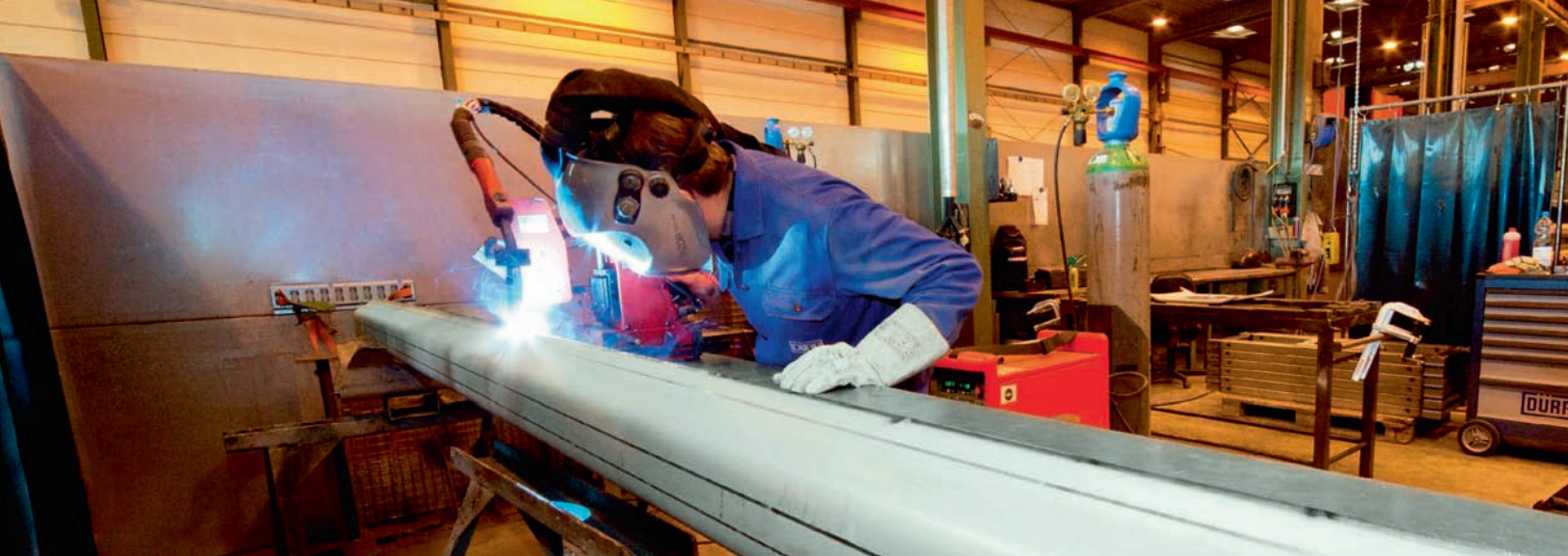
Der Fahrwagen FDV 22 MF führt Nähte ab einem halben Meter Länge mit dem Schweissystem TransPuls Synergic 2700 aus. Le chariot FDV 22 MF réalise les soudures à partir d'un demi-mètre de longueur avec le système de soudage TransPuls Synergic 2700.
