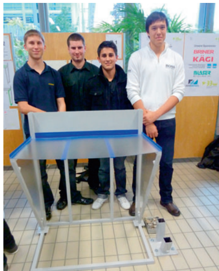
Filigrane Rohrkonstruktion mit schützenden Seitenabschlüssen. Nur das Verbundglas-symbolisierende «Plexi» zeigt einen kleinen Durchhänger.
