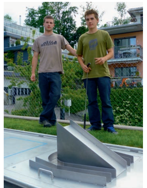
Sämtliche Schweißnähte waren sauber abzuweizen.
