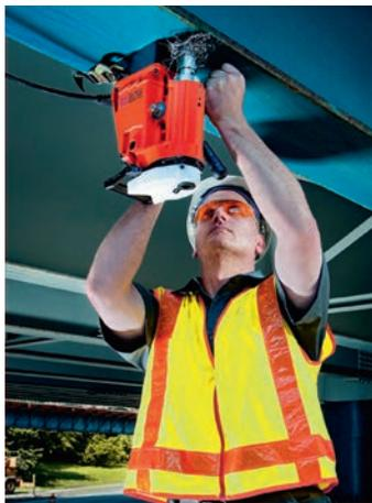
Bei beengten Platzverhältnissen empfiehlt sich der Einsatz der FEIN KBB 40. Mit nur 305 mm Bauhöhe bewegt sich der Bohrmotor während des Betriebes nicht nach oben.
