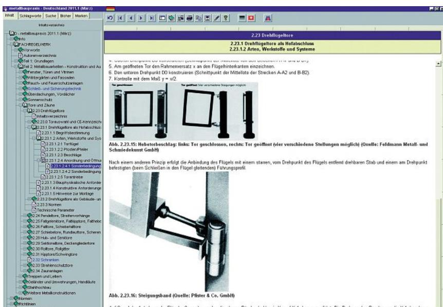
Abb. 2.23.15: Hebebeschlag: links: Tor geschlossen, rechts: Tor geöffnet (vier verschiedene Stellungen möglich) (Quelle: Feldmann Metall- und Schmiedekunst GmbH)
