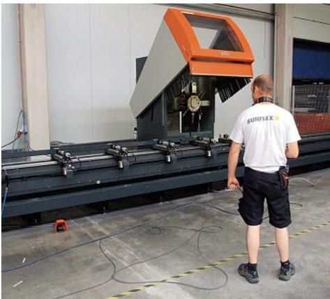
**3-Achs-Stabbearbeitungszentrum SBZ 130** von elumatec für die effiziente Bearbeitung von Aluminium-, Stahl- und Edelstahlprofilen. Bei dem Maschinenkonzept wird das ruhende Profil bearbeitet. Ein Revolverkopf mit acht Werkzeugen sorgt für sehr kurze Werkzeugwechselzeiten und optimierte Bearbeitungszyklen.
