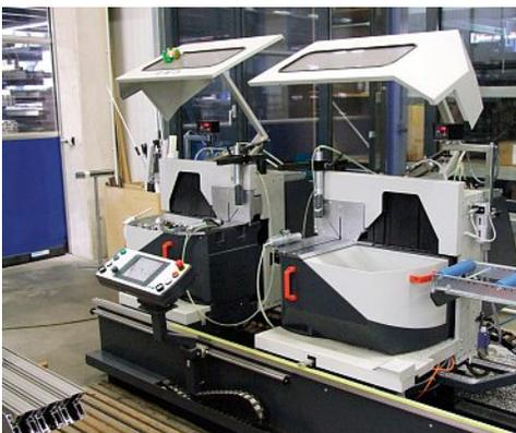
**Doppelgehrungssäge:** Durch das universelle Schwenken und Neigen der Sägeaggregate können auch hohe und breite Profile gesägt werden. Ausserdem lassen sich alle Arten von Schifterschnitten ausführen.
