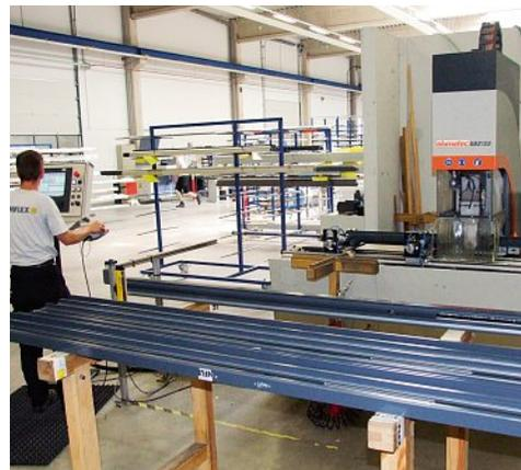
Das SBZ 122 eignet sich auch für die 5-Seiten-Profilbearbeitung. Eine in die Spindel integrierte Dreheinrichtung ermöglicht es, den Rotationswinkelkopf auf 0°, 90°, 180° und 270° einzustellen. Damit kann ein Profil von vorne, von hinten und stirnseitig mit 2 unterschiedlichen Werkzeugen bearbeitet werden.
