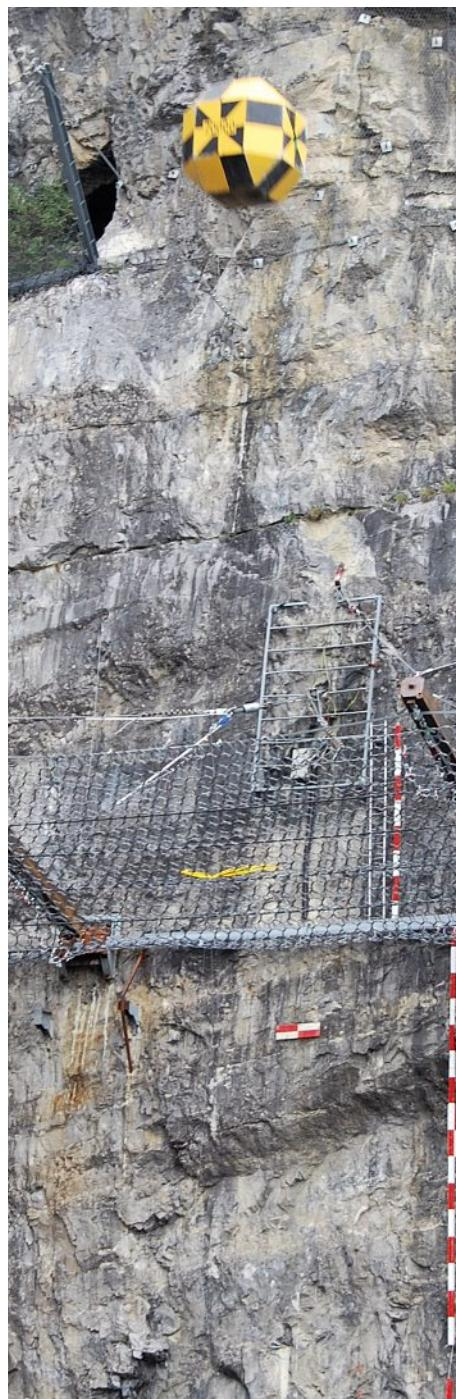
Mit über 100 km/h fällt der rund 2,5 Meter grosse Stein ins Netz.
