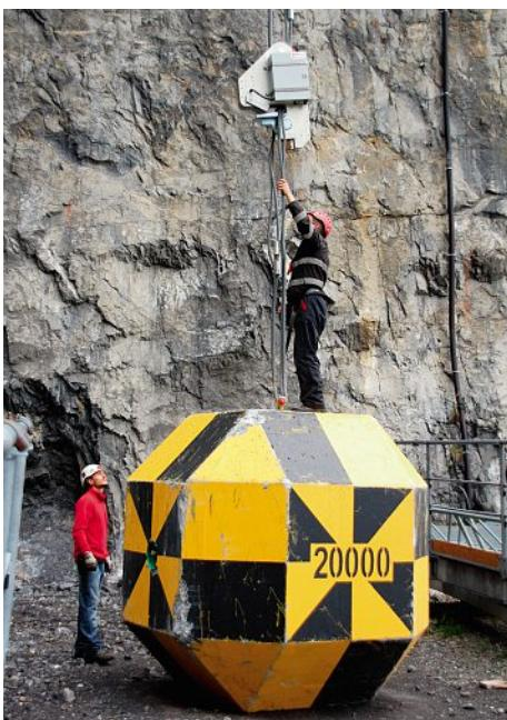
Der 20 Tonnen schwere Steinblock wird an der Steinschlag-Versuchsanlage Lochezen bei Walenstadt für den Aufzug bereit gemacht.
