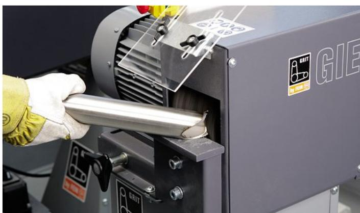
Effektives Entgraten mit einer Entgratmaschine mit Edelstahlbürsten
