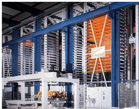
Längslagersystem UNILINE mit Blechvereinzellungseinrichtung
