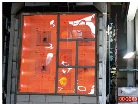
Brandprüfung E 30 einer Festverglasung. Test de tenue au feu E 30 d'un vitrage de fenêtre.
