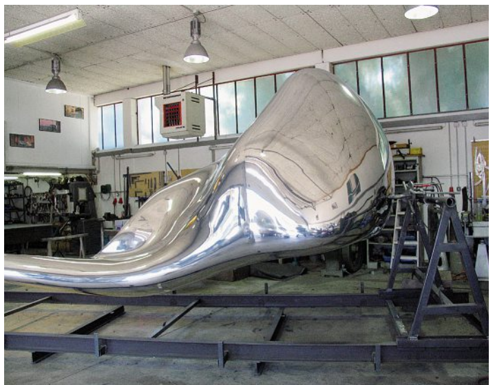
Zusammenbau und Schleifarbeiten erfolgten auf einer drehbaren Rahmen- vorrichtung. L'assemblage et le polissage ont été exécutés sur un châssis pivotant.
