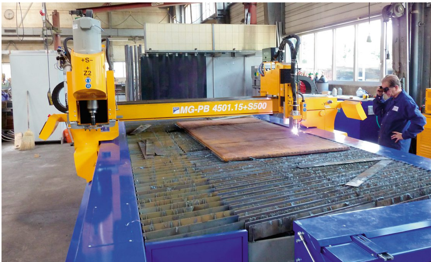
Die neue Plasmaschneidanlage im Werk der A. Lanz AG, im Einsatz.
