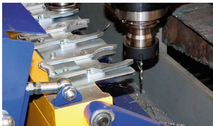
Automatischer Werkzeugwechsler für die Bohrarbeiten.
