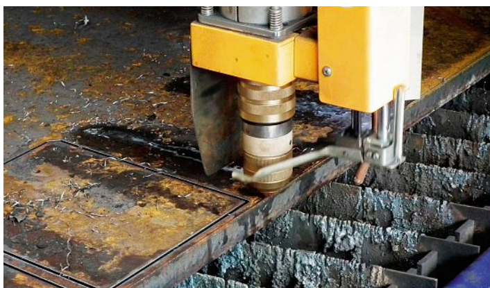
Präzise Schnitte bis 40 mm Blechstärke.
