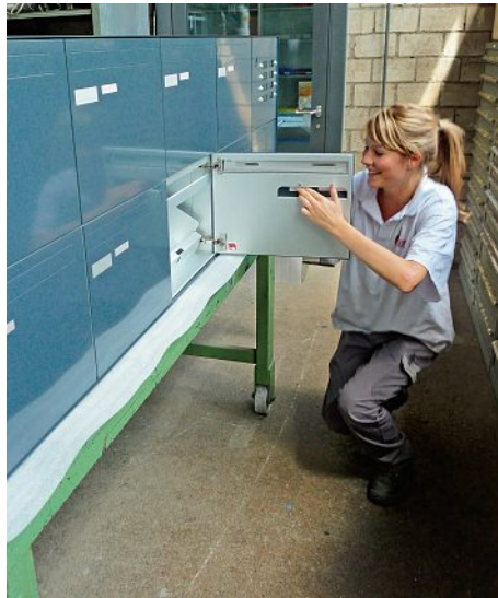
Auch bei den von Werner Keller Metallbau AG, Hergiswil, entwickelten Briefkastenanlagen werden die meisten Verbindungen geklebt. Même pour les ensembles de boîtes aux lettres conçus par Werner Keller Metallbau AG à Hergiswil, la plupart des raccords sont collés.
