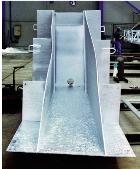
Die beim Verzinken abgebauten Eigenspannungen des dünnwandigen Bauteils zeigen, wie gross die Verformungen durch die Schweissspannungen sein können. Foto: Schmidt
