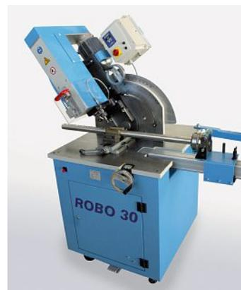
Die Geländerbohrfräsmaschine ROBO 30
