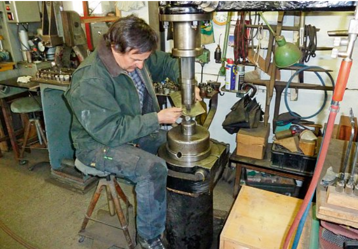
Moritz Häberling demonstriert das Treiben am mechanischen Treibhammer. Moritz Häberling fait la démonstration du bosselage sur marteau mécanique.
