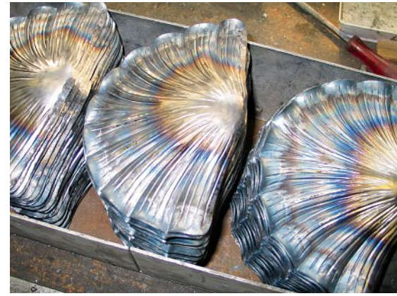
Eine Auswahl von getriebenen Ornamenten - die Muschelbleche.
