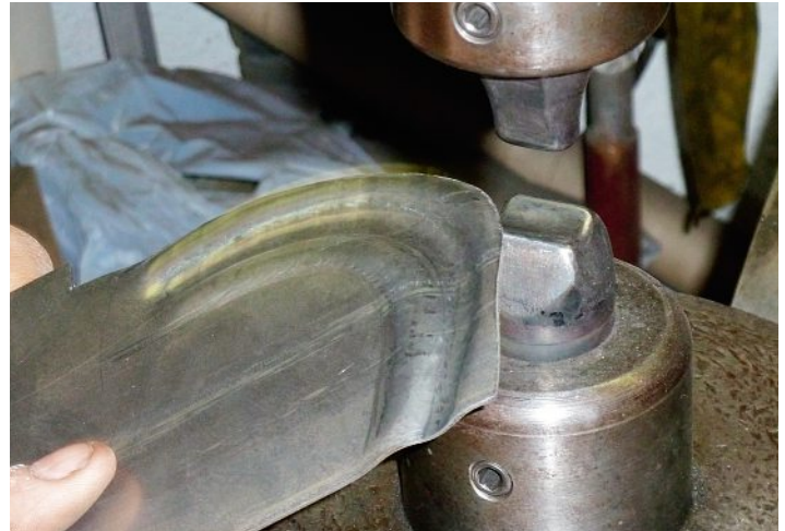
Eine grosse Auswahl an Gesenken und Stempeln ermöglichen beinahe uneingeschränkte Formgebungen.
