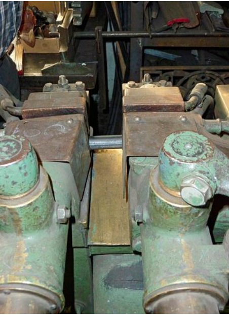
Der Rundstahl ist in der Widerstands-Stauchmaschine eingespannt. Le fer rond est serré dans la presse à refouler électrique.
