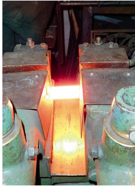
Der Stahl wird elektrisch erhitzt, bis er glüht. Mit Hilfe des Spindelrades werden die Spannbacken zusammengedrückt. L'acier est porté électriquement au rouge. Les mors sont resserrés par action sur la roue de la presse à vis.
