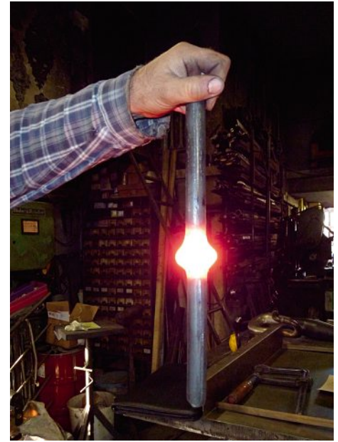
Die Stauchung ist perfekt. Le refoulement obtenu est parfait.
