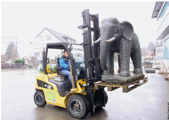
Werksleiter Franz Kuster hebt mit dem Drei-Tonnen-Treibgasstapler Caterpillar GP30N sogar Elefanten an.
