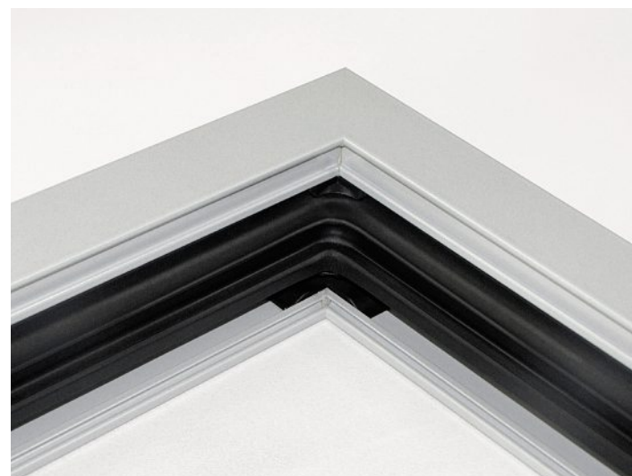
Die rundumlaufende Mitteldichtung mit ihrer faltfreien glatten Ausbildung in den Ecken, ist der Grund für die hohe Dichtigkeit der Fenster.
