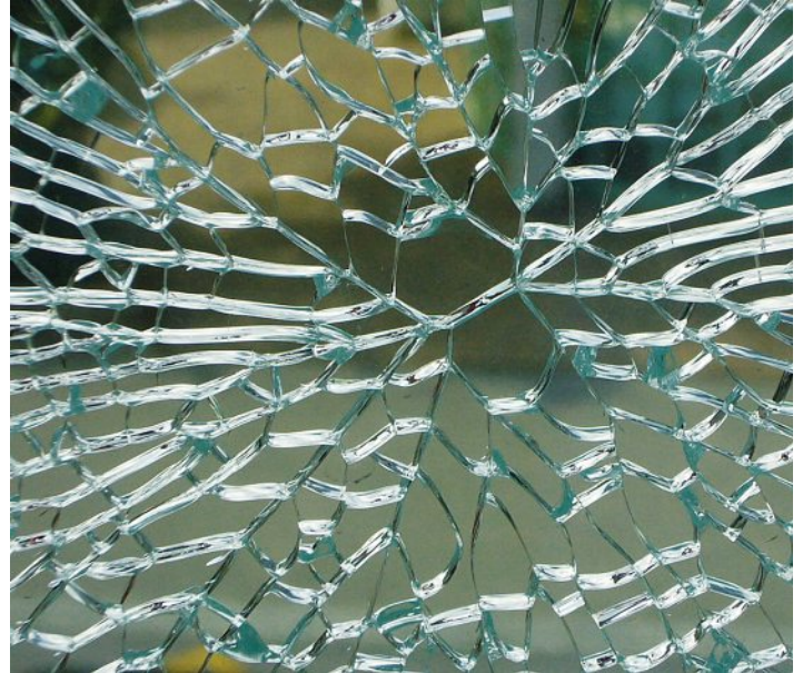
III. 4 : Inclusion de sulfure de nickel dans du verre de sécurité
