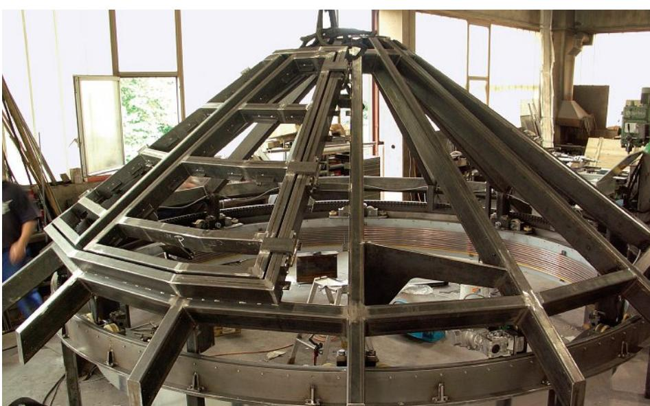
Blick in die Produktion: Die ganze Konstruktion wird im Werk zusammengestellt und an einem Stück mit dem Heliokopter an den Zielort transportiert.
