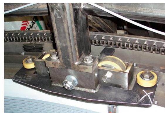
Blick an die Mechanik während des Probelaufs im Werk: Die Konstruktion ist auf den beweglichen Rollenböcken gelagert. Die Horizontalrollen gewähren die Führung. Zahnradantriebe wirken auf die im Innenradius angebrachte Rollenkette.
