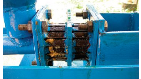
Der Filter besteht aus einem Flachstahlgitter mit je 0,25 mm Luftzwischenraum. Le filtre se compose d'un treillis en acier plat avec des interstices de 0,25 mm.
