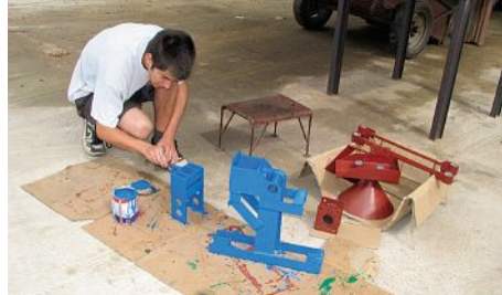
Grundierung und Deckanstrich mit dem Pinsel. Für die Einbrennung ist die Sonne zuständig. Sous-couche et revêtement au pinceau. C'est le soleil qui assure la prise.
