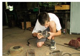
Die aus Stahlblech ausgeschnittenen Platten werden am Boden zusammengesweisst.
