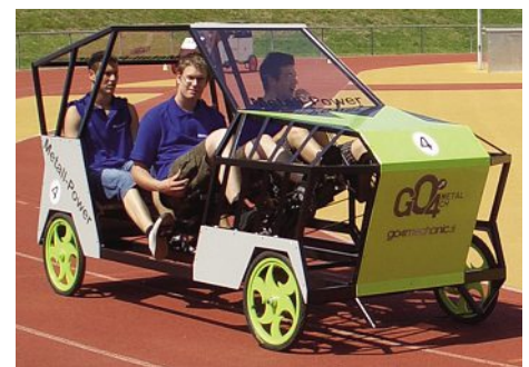
Die Gruppe 4, Sieger des Qualitätswettbewerbs. An diesem Fahrzeug ist kaum ein Profil zu finden, das im rechten Winkel angesetzt ist. Le groupe 4, vainqueur du concours de qualité. Ce véhicule ne présente pratiquement aucun profil assimilable à un angle droit.
