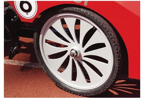
Aus Laserblechen hergestellte Felgen. Des jantes découpées au laser.
