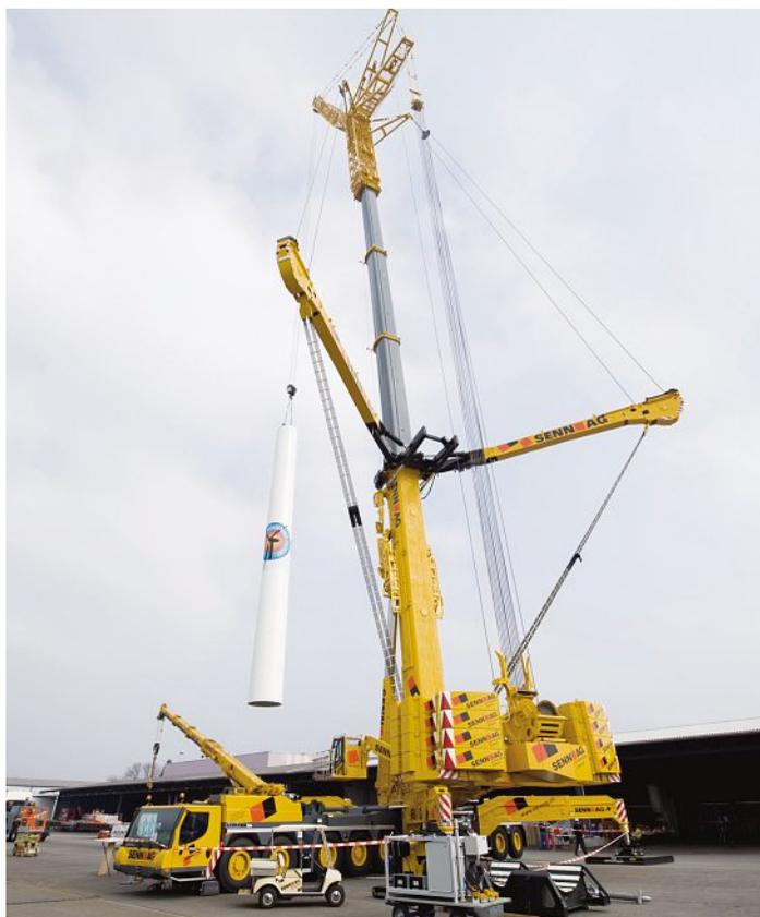
Der stärkste Teleskopkran der Welt: Der Neunachser-Kran kann bis zu 1200 Tonnen heben und bringt selber 108 Tonnen auf die Waage.
