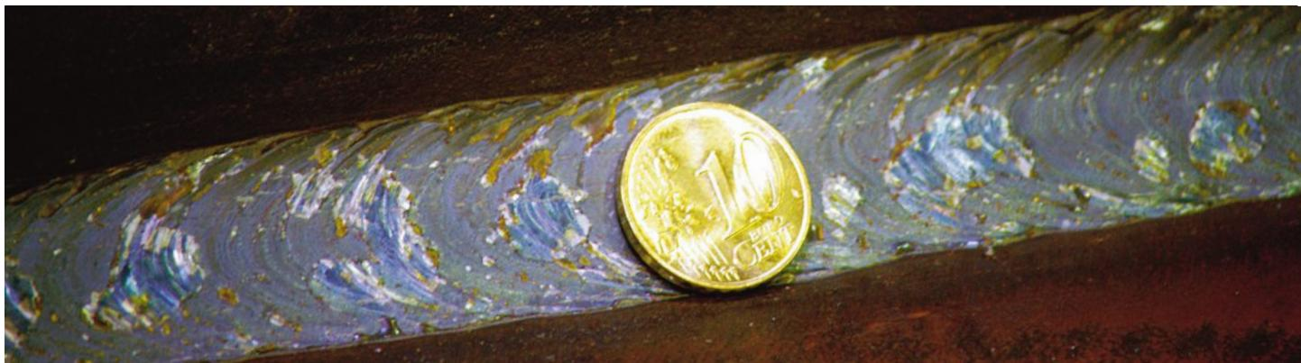
Die wichtigsten Vorteile im Vergleich zu konventionellen Kennlinien sind ein tieferer Einbrand, höhere Schweißgeschwindigkeiten und eine höhere Abschmelzleistung.
