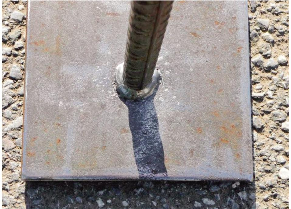
Des matériaux contrôlés ont dû être utilisés pour la plaque frontale ; la société doit avoir fourni une attestation pour le soudage des aciers d'armature.
