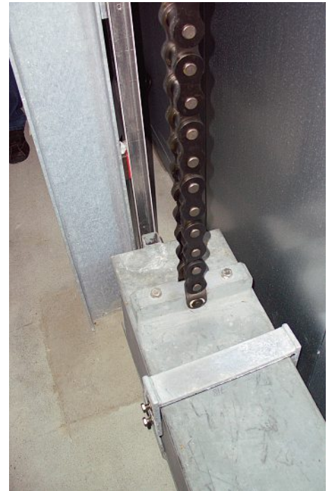
Das Gegengewicht - ein HEB-Träger - mit den eingeschobenen Flachstahlplatten, an der Kette hängend.
