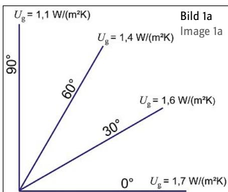
$U_g$ -Wert für 2-fach- und 3-fach-Isolierglas in Abhängigkeit von der Neigung. Glasaufbau: 4/16/4 und 4/12/4/12/4 mit 90% Ar und Emissionsgrad 0,03 mit Beschichtung auf Position 3 bzw. Position 2 und 5.
