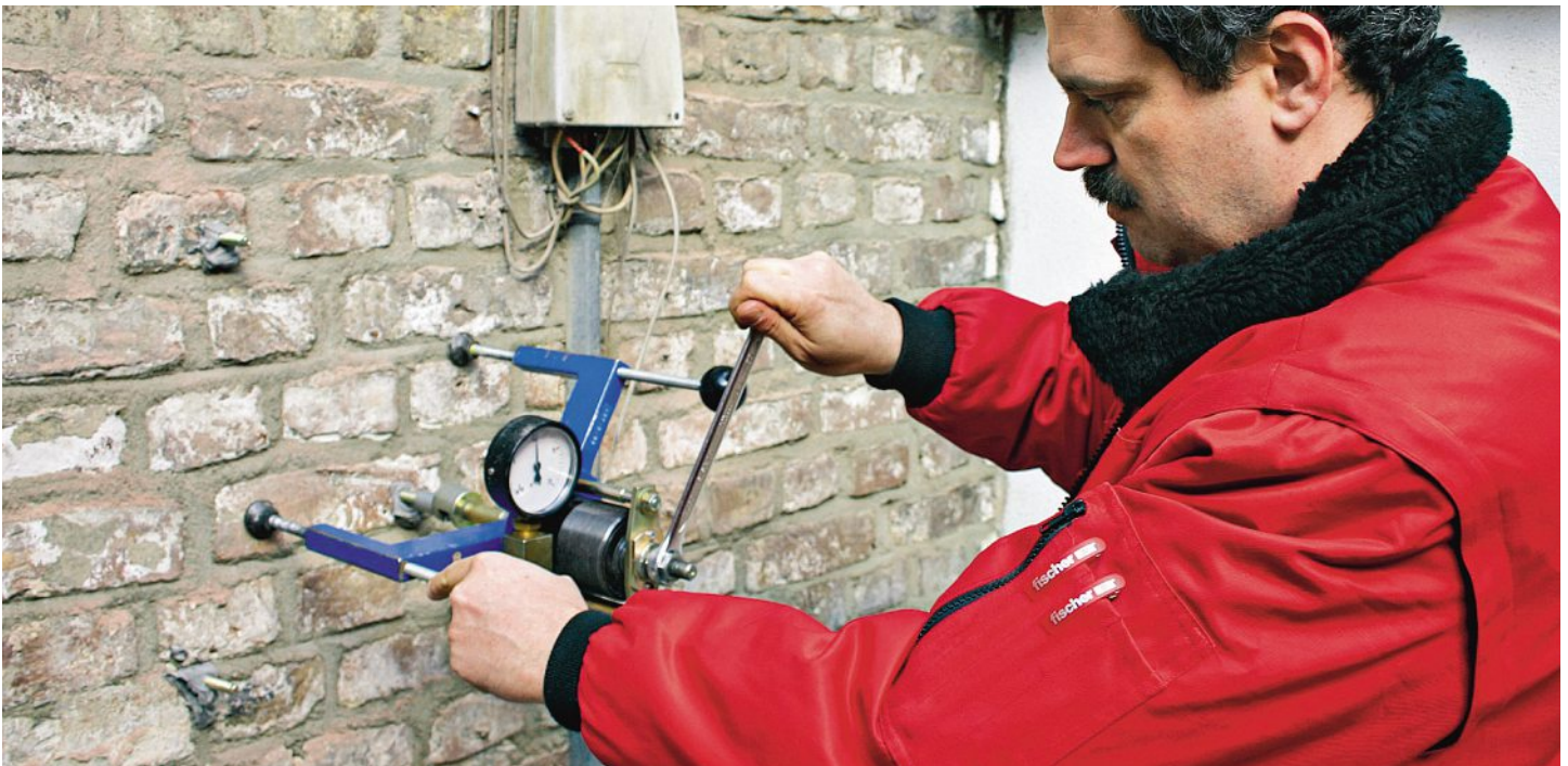
Bei undefinierten Bauuntergründen müssen Auszugsversuche durchgeführt werden. Des tests d'arrachement doivent être effectués si la base de la construction est inconnue.
