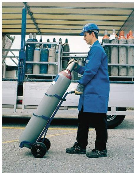
**Druckgasflaschen nach Möglichkeit fahren.**
