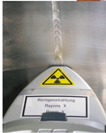
Legierungsanalyse der Schweissnähte eines Schwimmbeckens aus nicht rostendem Stahl.
