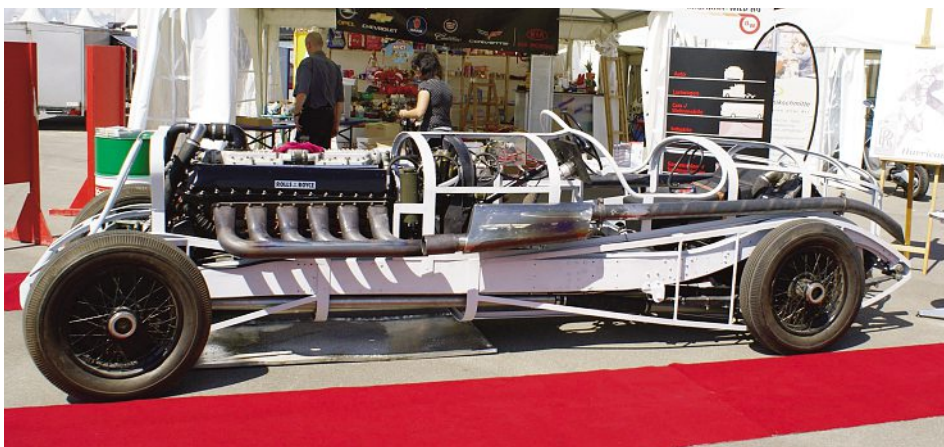
Blick unter die Haube: Auspuffrohre mit grosszügiger Wandstärke – ausreichend für die nächsten 80 Jahre.
