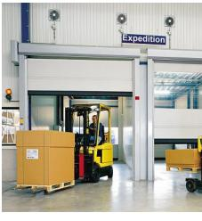
Die Schnelllauftore für den Innenbereich verfügen über Soft-Edge-Technologie, ein vertikal flexibles Abschlussprofil. Dieses Merkmal biegt sich bei Auftreffen auf ein Hindernis durch. Kosten durch Materialschäden werden weitestgehend vermieden.
