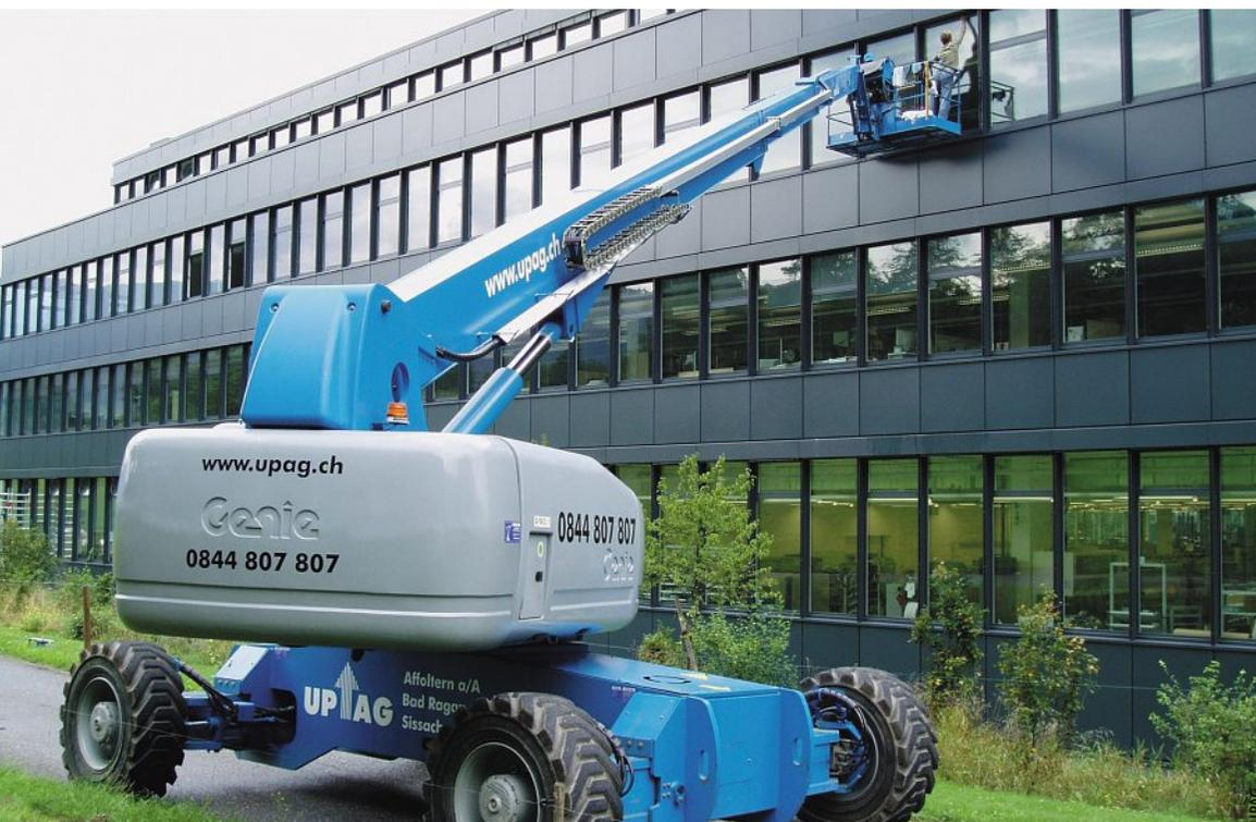
Ein Reinigungskonzept mit Hebebühnen setzt voraus, dass genügend befahrbare Grundfläche zur Verfügung steht.
