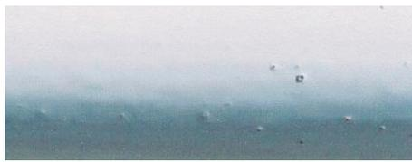
**Zahlreiche harte und spitze Pusteln auf den Geländerhandläufen. Sogenannte Pinholes, entstehen durch Ausgasungen der frischen Zinkschicht beim nachträglichen Pulverbeschichten.**
