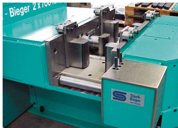
Die Zuführung der Profile von oben ermöglicht ein einfaches Richten des Werkstücks.
