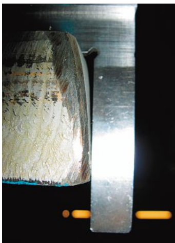
Vergleich Winkligkeit der Schnittkante bei T = 40 mm (Plasma - Wasser - Laser). Comparaison de l'orthogonalité des chants pour T = 40 mm (plasma - eau - laser).
