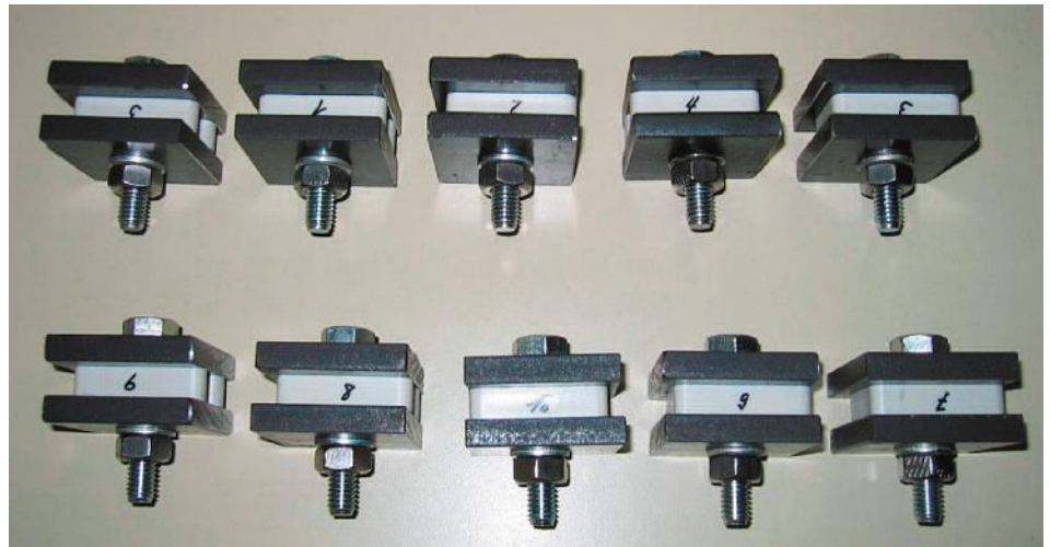
Test von Kunststoffunterlagen auf Schwindung oder Quellung. Test de retrait et de gonflement des supports en plastique.
