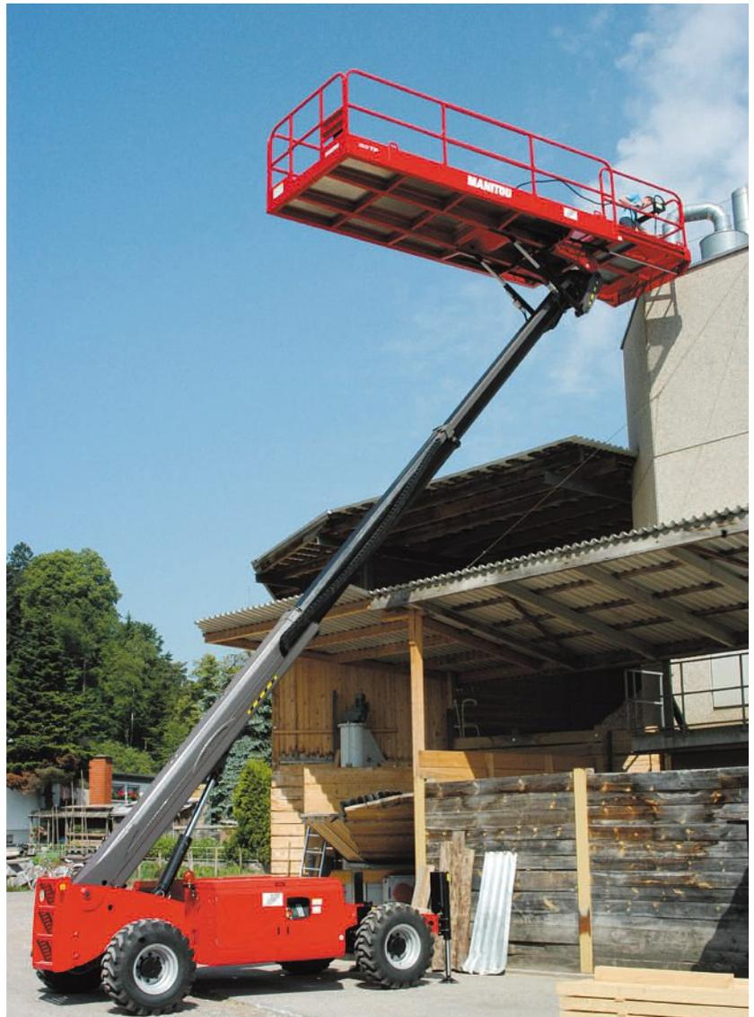
Mit der 150 TP von Manitou können von einem Standort aus Montagearbeiten an 170 m<sup>2</sup> Fassadenfläche ausgeführt werden.
