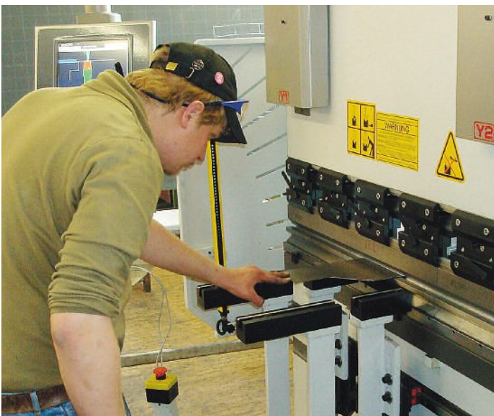
Eine echte Aufwertung für die Schulhauswerkstatt: die neue CNC-gesteuerte Abkantpresse.
